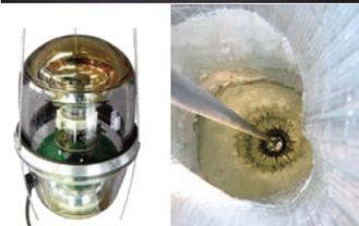
南極点のニュートリノ観測施設と千葉大チーム開発の新型光検出器「D-Egg」（下段左図）
