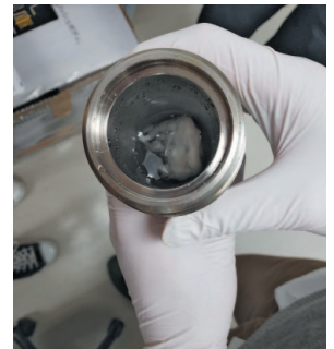
実験で生成した 二酸化炭素ハイドレート
