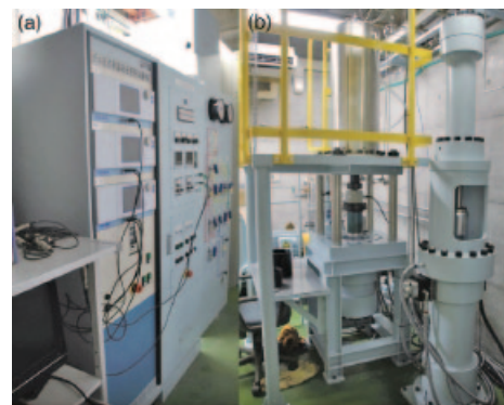
ガス圧式高温高圧三軸試験機の(a)制御部と(b)試験機本体。地下の温度圧力を再現した実験をおこなうのに使用します。
