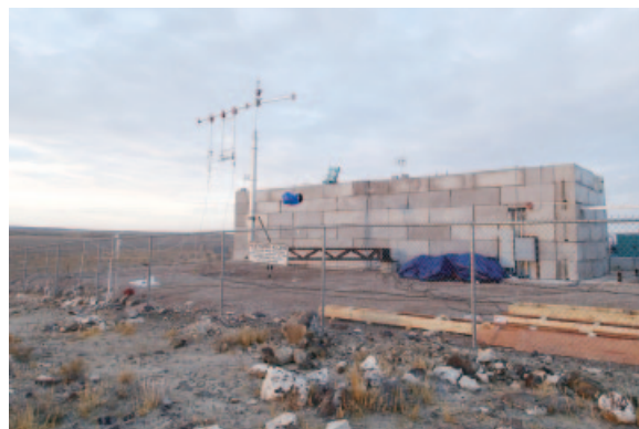
アメリカ・ユタ州砂漠地帯での実験の様子。宇宙ニュートリノ測定用の電波検出器が手前のタワーに吊り下げられている。奥のコンクリートブロックの上に見えるのが100kgの水で、下から電子ビームを照射する。2015年1月11日撮影
