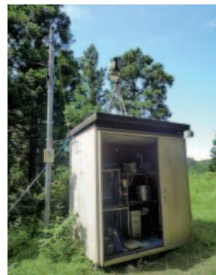
図2 鴨川の清澄観測点 大気電場、大気ラドン濃度、大気イオン濃度、地球磁場、地球電場、気象パラメータが観測されている。
