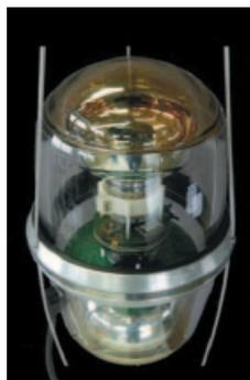
図1 千葉大学で開発中のD-Egg光検出器稼働中の光検出器の約2倍の感度を持つ
