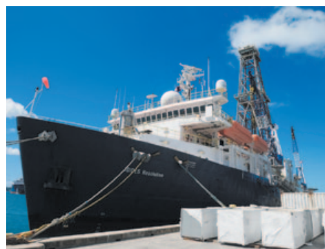
掘削船ジョイデス・レゾリューション。そびえ立つ構は、掘削パイプを繋ぎ合わせて海底に下すためのものである。
