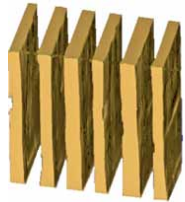
SHG顕微鏡を用いて観察したQPMの分域構造
