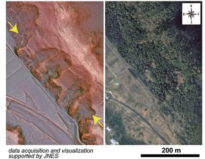
航空レーザー測量結果の例(岐阜県根尾谷断層北部郷付近の赤色立体地図)。黄色矢印は根尾谷断層のトレースを示す。右は同じ範囲の空中写真。航空レーザー測量では空中写真では全く認識できない活断層微地形や崩壊地形、人為地形(江戸時代の街道跡や大正時代の発電用水路跡)を明瞭に捉えることができる。
