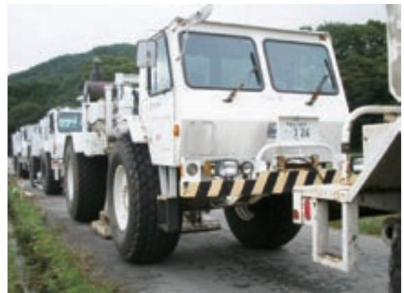
パイロサイス4台を連結して発振(伊那盆地にて)
